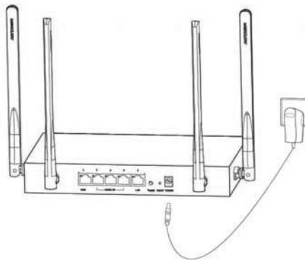
图 4-2 电源连接示意图
