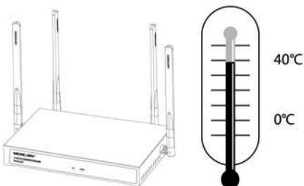
为保证路由器长期稳定工作，延长使用寿命，请维持环境一定的温度和湿度。过高或过低的环境湿度易引起绝缘材料漏电、变形甚至金属部件锈蚀现象，温
